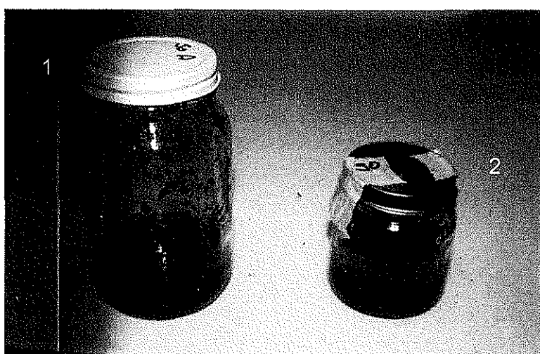
Figura 7. Frascos que contienen caldo selenito (1) y caldo tetratonate (2) inoculados con muestras de sólido.
