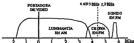
Figura 1-25.- Espectro de banda de un canal de televisión SECAM.
