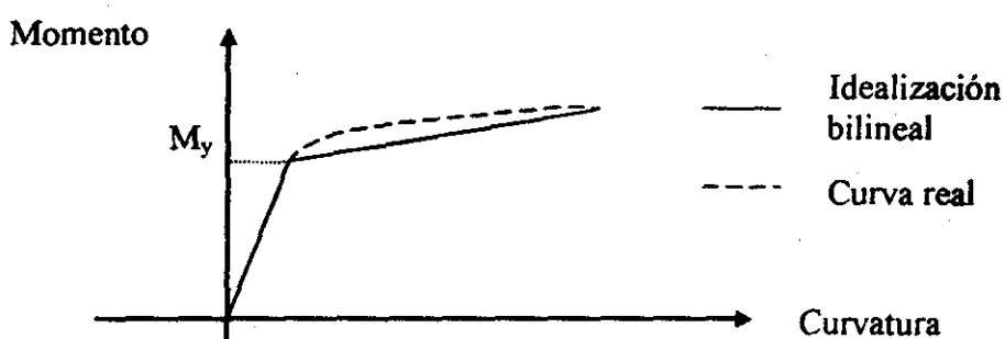
Fig 2.3 Aproximación bilineal del diagrama momento-curvatura
