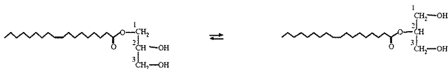
Figura 5.4. Esquema de reacción de la migración acilica de monooleina.
