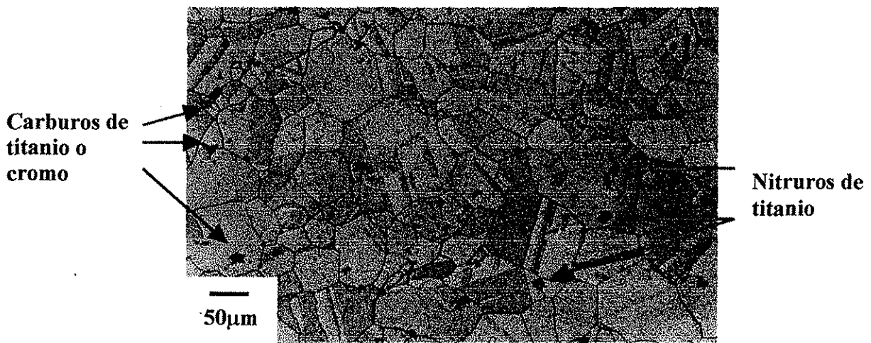
Figura III.18. Microestructura inicial del Incoloy-800 a 200x.
