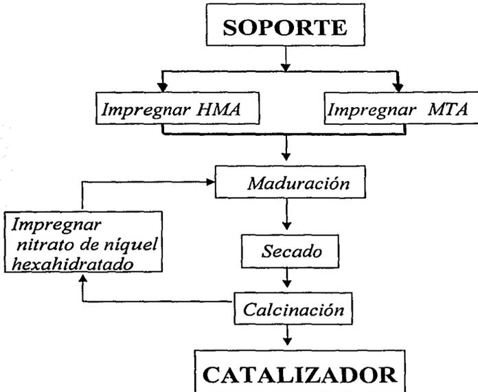
Figura 3.2. Diagrama de flujo para la preparación de catalizadores
