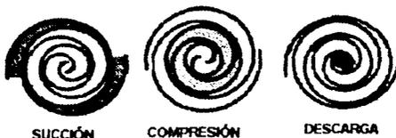
FIG. 3.2 PROCESO DE COMPRESIÓN SCROLL
