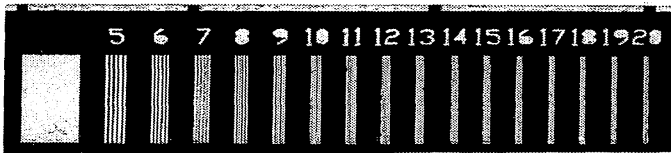
Figura 1.22. Patrón de barras de 5 a 20 lp/mm.
