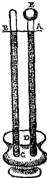
Figura 1.1 Barómetro construido por Torricelli en 1644. 5
