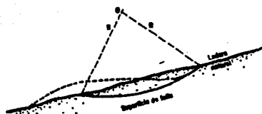
c) Falla superficial
