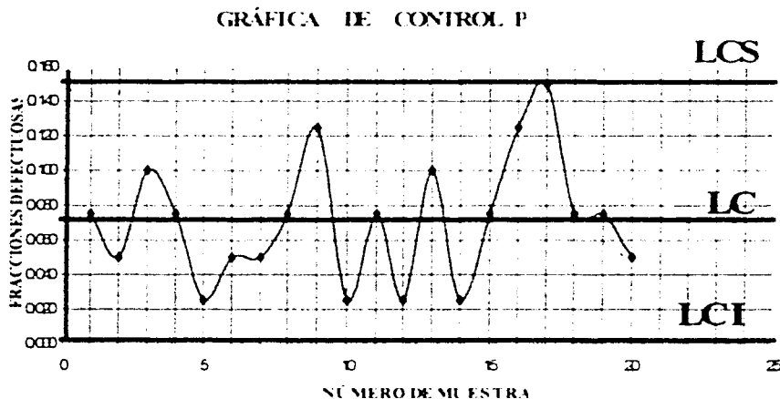
GRÁFICA 4.5.1. GRÁFICA DE CONTROL P PROPUESTA PARA LA INSPECCION DEL PRODUCTO TERMINADO.
