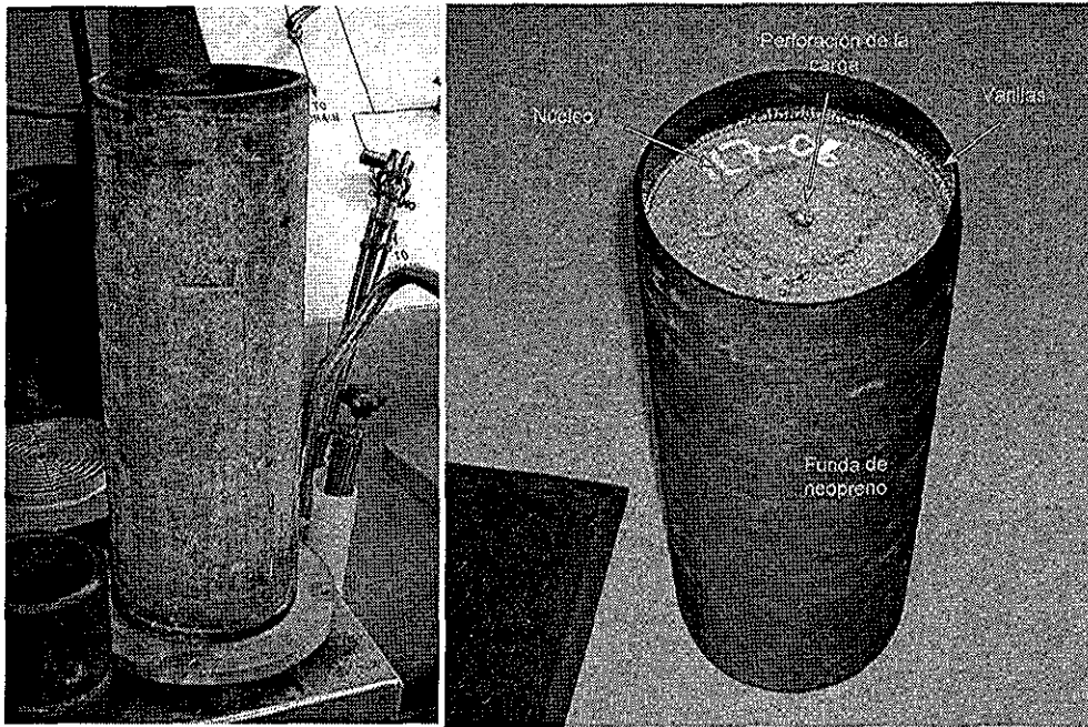
Figura 55 Funda o camisa de hule para aislar núcleo y muestra (núcleo) disparado dentro de la camisa de hule
