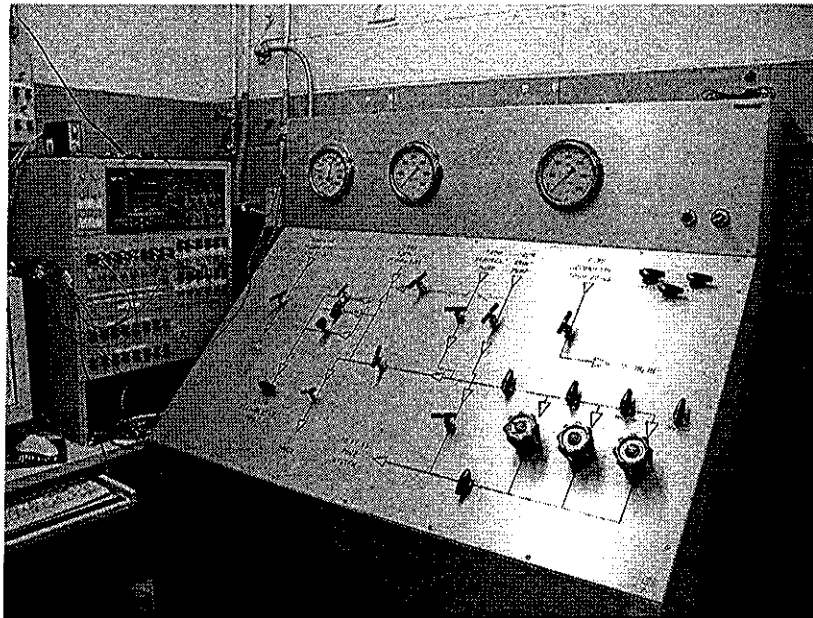
Figura A 11 Fotografía del Tablero de control de presiones. Cortesía SRC, Schlumberger
