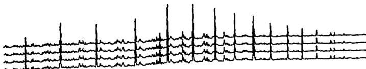
Figura 4.3 Cromatogramas de la evaluación del rango de hidrocarburos contenidos en una muestra de Diesel.
