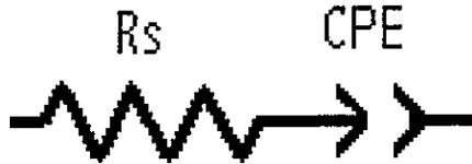
Figura 4 17 Circuito equivalente A, una resistencia y un elemento de fase constante en serie que describen el comportamiento de la interfase semiconductor-electrolito
