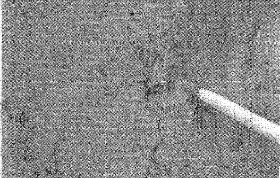
Fotografía 1.1. Material incrustado en el interior de las tuberías del acueducto
