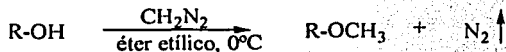
Figura 12. Reacción de metilación a partir de \text{CH}_2\text{N}_2 en éter etílico a 0^{\circ}\text{C} .
