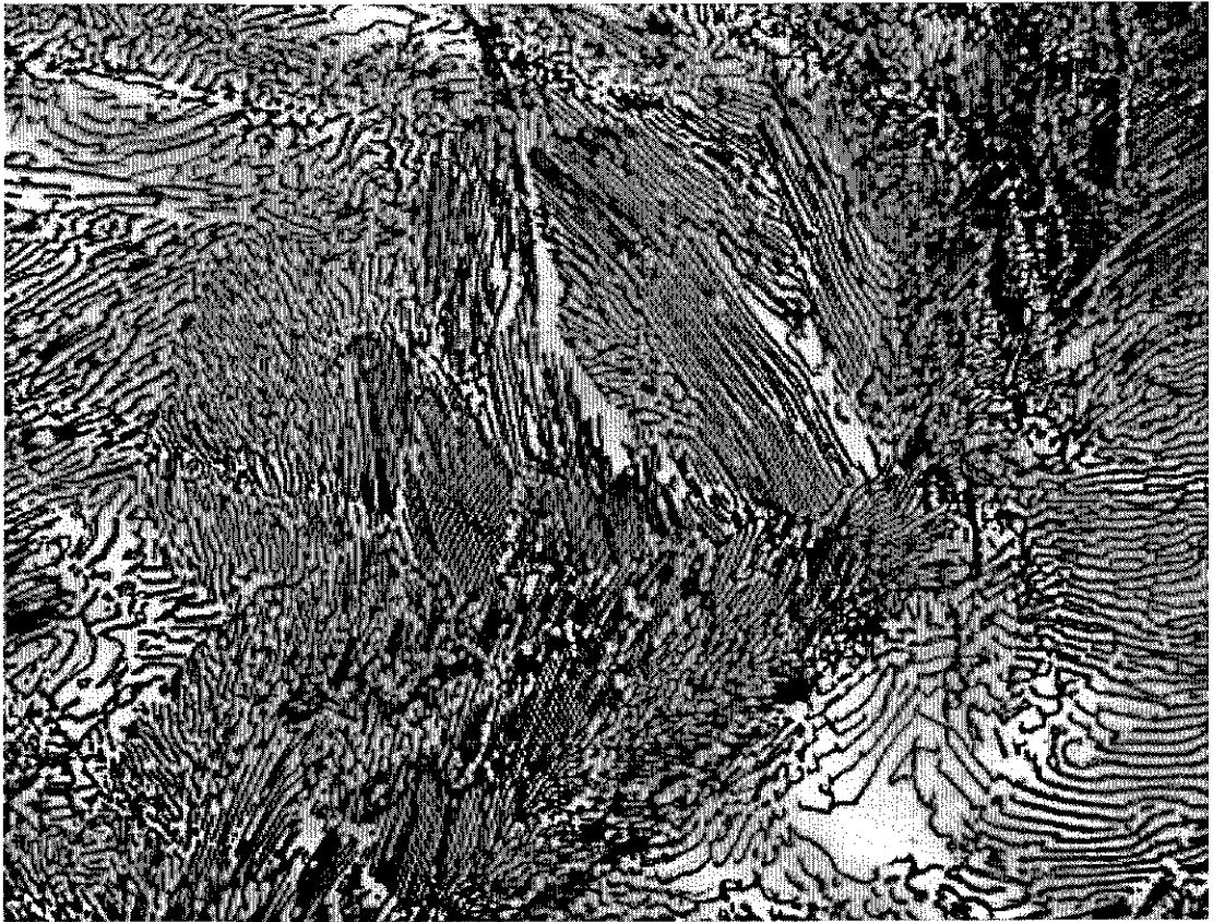
Figura I.5. Colonias de perlita con distintas orientaciones y espaciamiento. Acero con 0.75% de C-0.8% Mn enfríaada en el horno desde 750 °C (24) . (500X).
