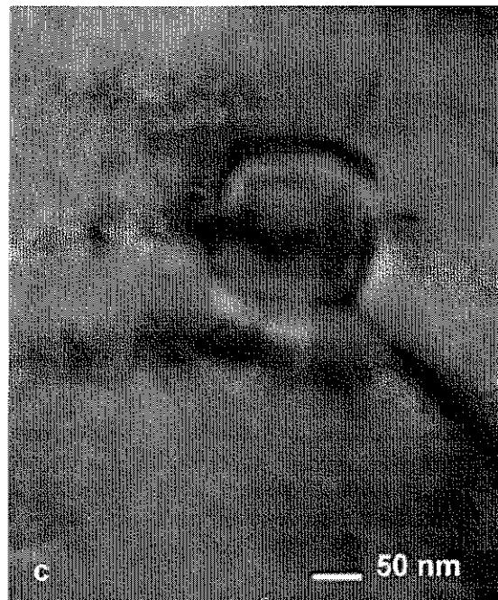
Figura VI. 1 a, b, y c. Microscopía electrónica de transmisión de una serie de precipitados de Nb que se encuentran intreraccionando con dislocaciones. Esta muestra corresponde a una de las barras de refuerzo laminadas en caliente (Acero B tabla III.1)III
