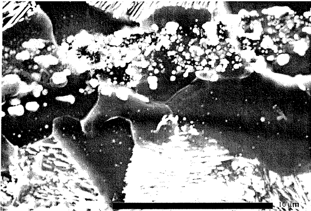
Figura VI.4. Forma de inclusiones encontradas en las palanquillas. Se observan inclusiones pequeñas globulares y alineadas en forma de hebras.
