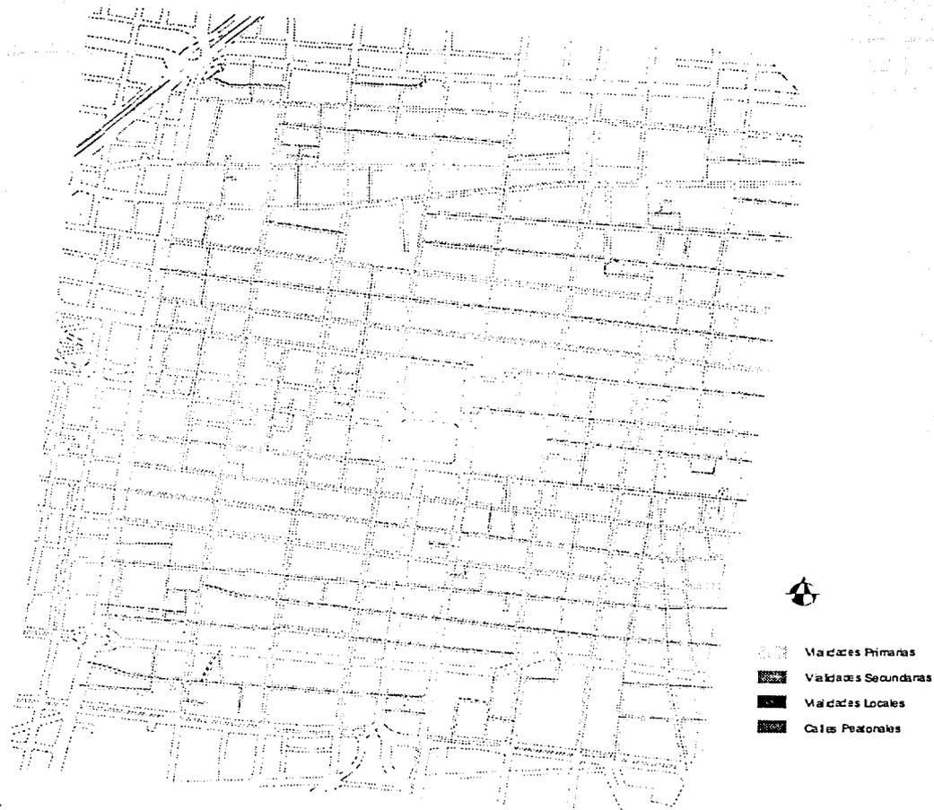
Figura 4- 13. Trazo de la red mostrando la clasificación de las vialidades con base en datos de la SETRAVI y correcciones derivadas de observaciones de campo.
