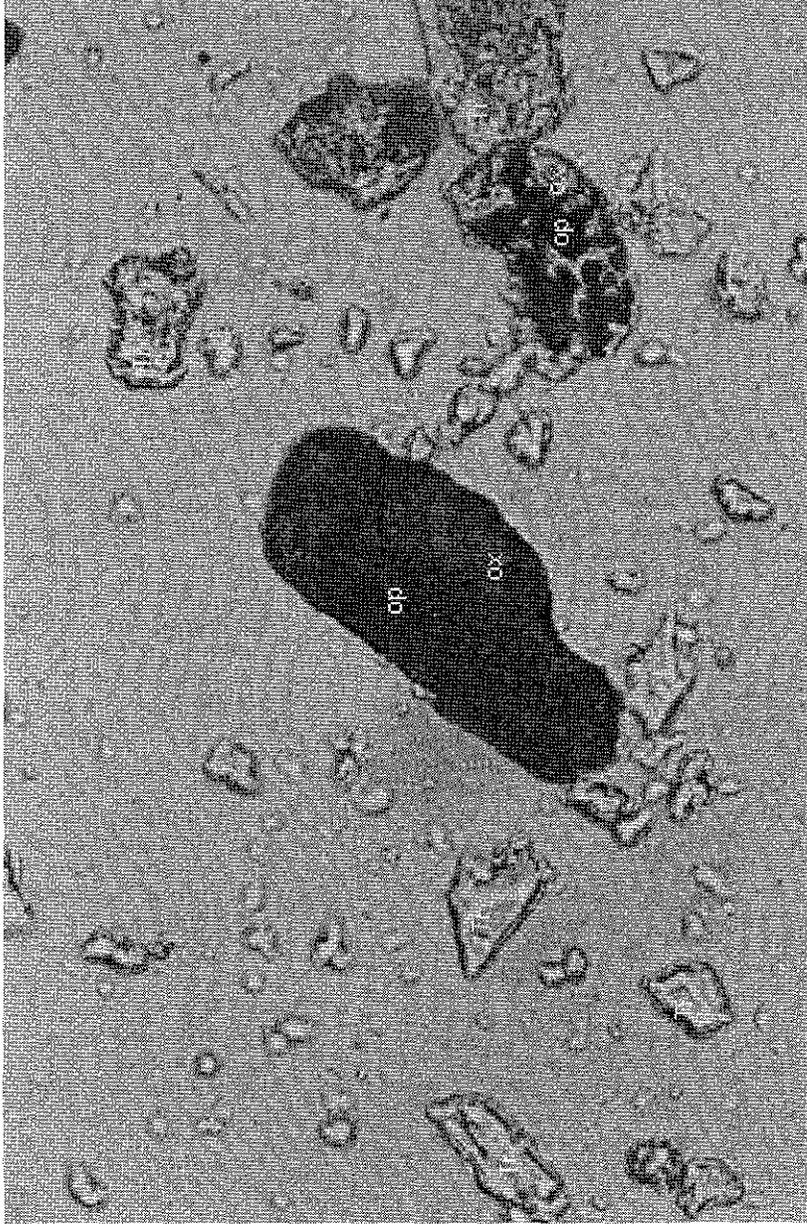
Fotografía 5.- Fotomicrografía al MOP-LT, muestra granos transparentes (Tr) liberados y oxidación penetrativa en los granos transparentes por los opacos (op). Objetivo 40X, Nícoles paralelos, campo horizontal de la fotografía 0.25 mm.
