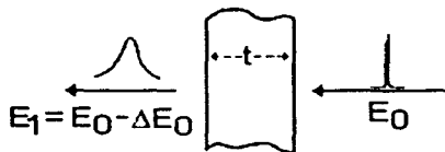
Fig. 1.30 Diagrama esquemático para ilustrar el esparcimiento de energía. La dispersión de energía de los iones incidentes puede representarse por una \delta de Dirac.
