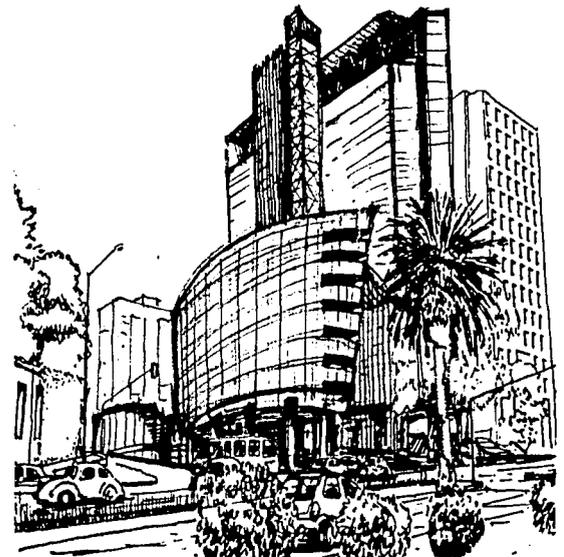
Dos volúmenes complementan el conjunto: la casa de máquinas del edificio: un caja de dimensiones iguales de planta y alzado; y un volumen cilíndrico, en el que se desarrolla el acceso al METRO. Éstos dos volúmenes se integran bajo una misma cubierta metálica y que por su altura se integran de manera gentil hacia la zona de Tizapán en San Ángel.
