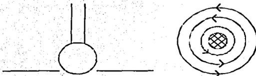
figura 3.1 Flujo con simetría axial, no hay perturbación en la superficie del fluido y las líneas de flujo forman círculos concéntricos a la esfera.
