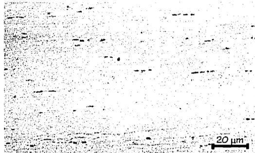
Figura 4. Fotomicrografía de la estructura deformada del acero ultralimpio laminado en frío.
