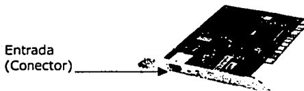
Figura 1.4. Tarjeta de Interfaz de Red (NIC)
