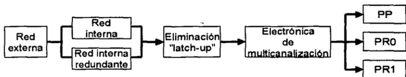
Figura 5.6 Diagrama de bloques de confiabilidad de la arquitectura redundante en ambiente de vuelo espacial
