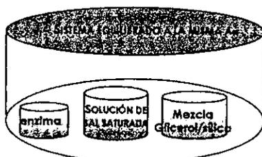
FIGURA 22 . Representación esquemática de la técnica para equilibrar  $a_w$  de la enzima y la mezcla glicerol/silica a un mismo valor
