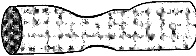
Fig. 1.6.1. Ducto con anomalías geométricas
