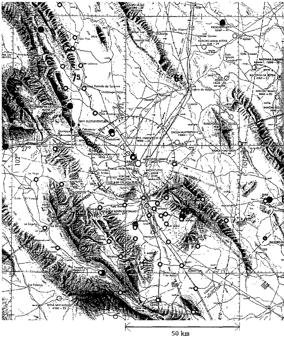
Figura V.4.a- Localización de la red pluviográfica instalada en los alrededores de Monclova en el verano del 98.
