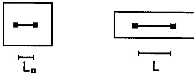
FIGURA 4.3. Separación de dos partículas localizadas en la misma línea de flujo durante extensión simple.
