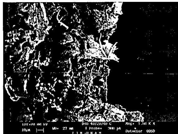
Micrografía 4.26. Orilla de la membrana 40PP/20EVA/40ELVANOL, con deformación extensional de 1.2 mm/mm.
