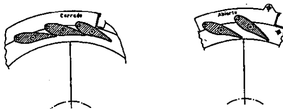
Figura 4.9 Detalles de la posición de los álabes directrices de una turbina Francis.
