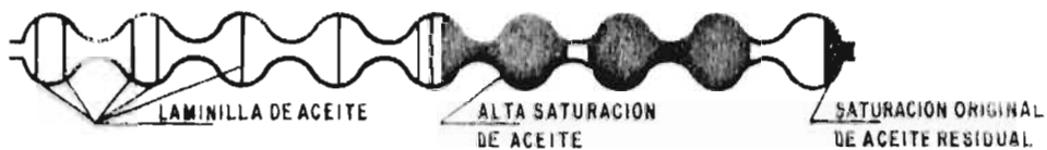
Fig. N o 7.- DISTRIBUCION DE PRESION Y FLUIDOS EN UNA COLUMNA DE ARENA DURANTE UN BARRIDO CON AGUA ALCALINA (3)
