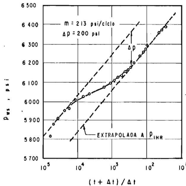
FIG. N° 9 : CURVA DE INCREMENTO EN UN YACIMIENTO FRACTURADO.<sup>(4)</sup>
