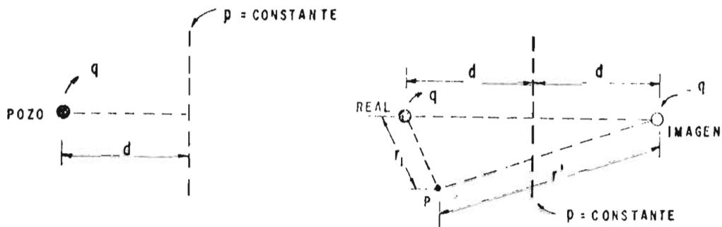
FIG. N°E-2: POZO IMAGEN EN UN YACIMIENTO CON UNA FRONTERA A PRESION CONSTANTE.
