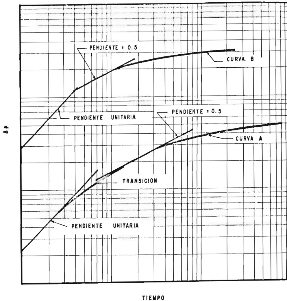
FIG. N° 24.- COMPORTAMIENTO GENERAL DE DATOS DE PRESION DE UN POZO FRACTURADO CON ALMACENAMIENTO<sup>(6)</sup>.
