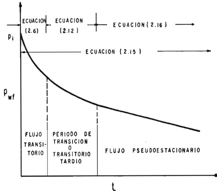
FIG. N° 5: COMPORTAMIENTO DE LA PRESION DE UN POZO CON GASTO CONSTANTE (9).
