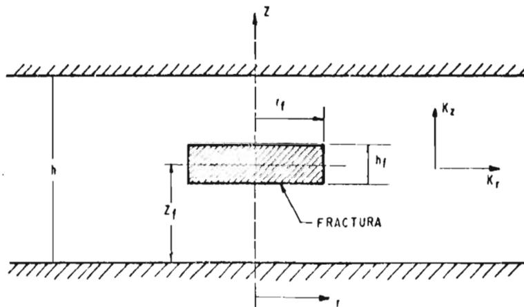
FIG. Nº 11.- MODELO DE FRACTURA HORIZONTAL<sup>(8)</sup>.
