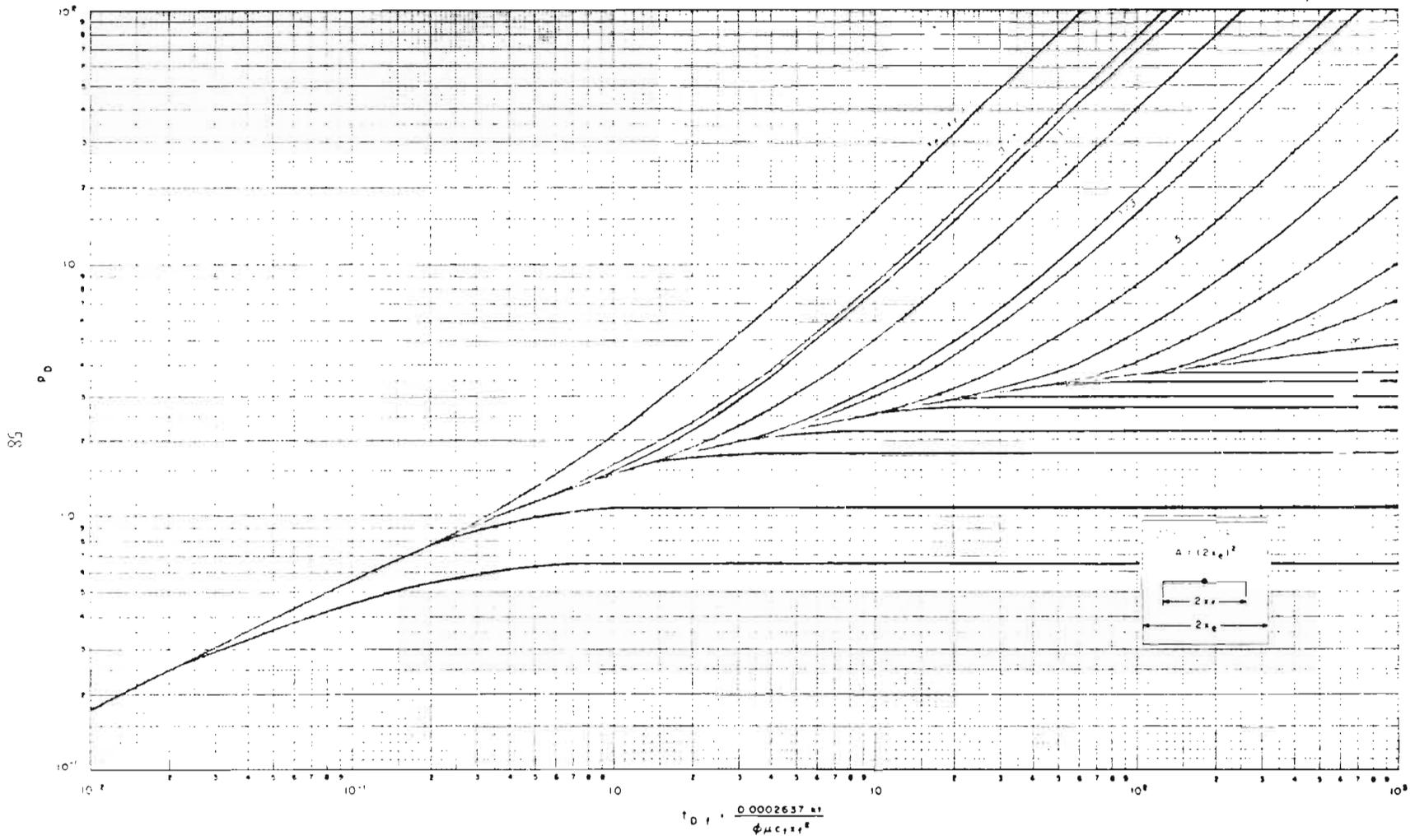
FIG. No. 19.- PRESION ADIMENSIONAL PARA UNA FRACTURA VERTICAL CON FLUJO UNIFORME EN UN POZO EN EL CENTRO DE UN CUADRADO CON FRONTERAS CERRADAS Y A
