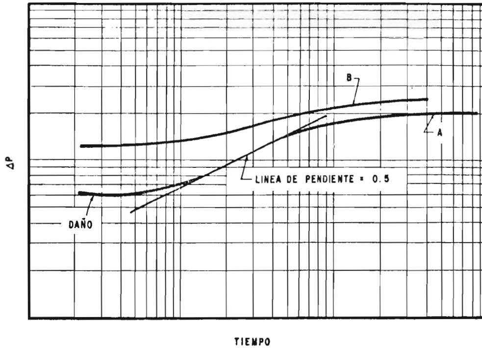
FIG. N° 22.- TENDENCIA GENERAL DE LOS DATOS DE PRESION DE UN POZO FRACTURADO CON EFECTO DE DAÑO<sup>(31)</sup>.
