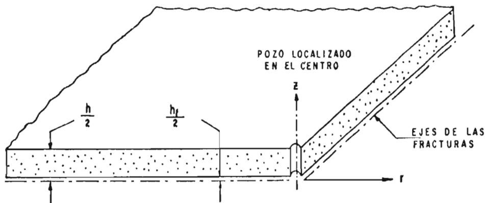
FIG. Nº 10 - MODELO DE YACIMIENTO CON FRACTURA HORIZONTAL <sup>(5)</sup>
