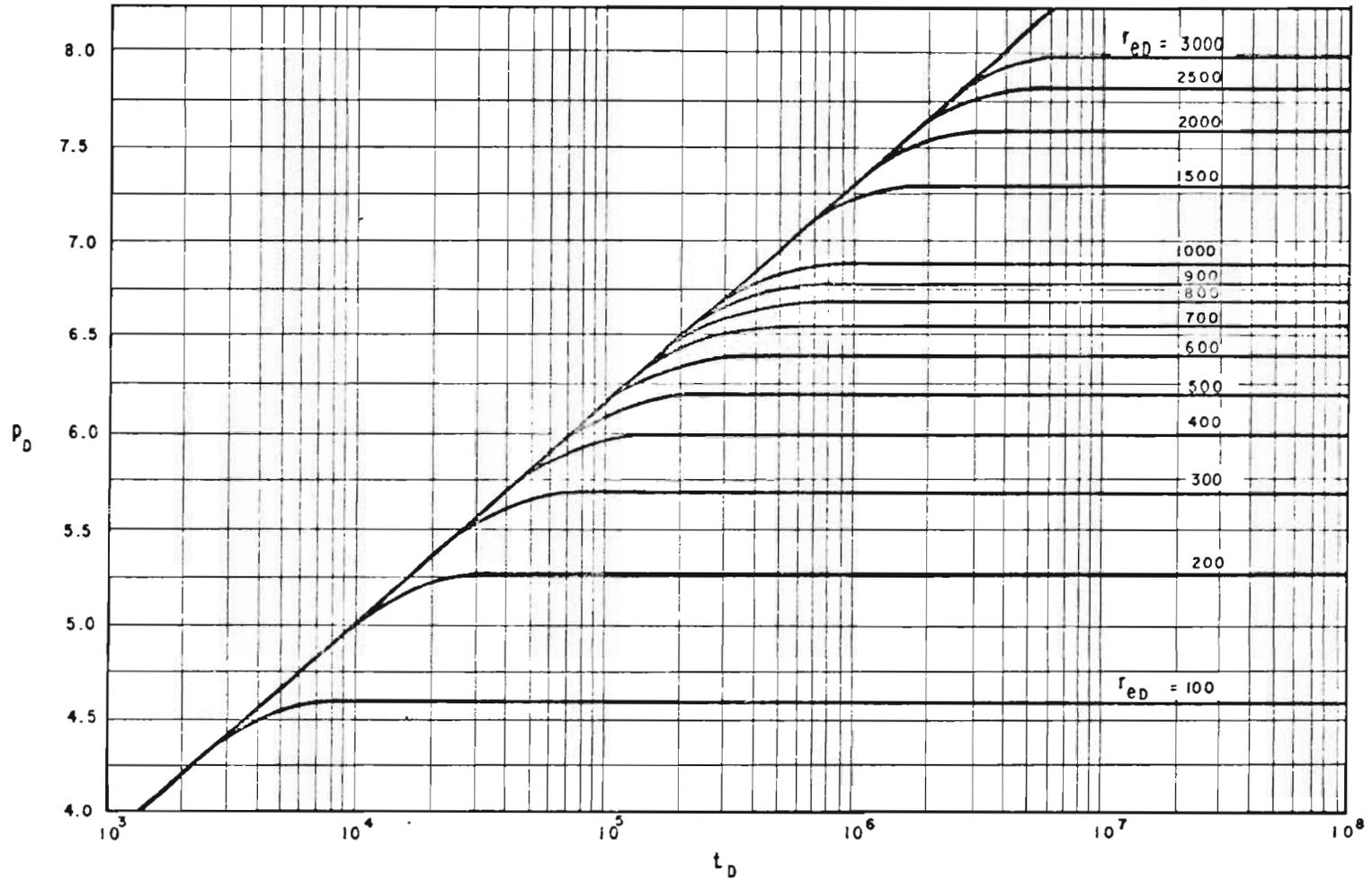
FIG. N° 4: SOLUCION PARA UN YACIMIENTO CON PRESION CONSTANTE EN LA FRONTERA EXTERIOR<sup>(13)</sup>.
