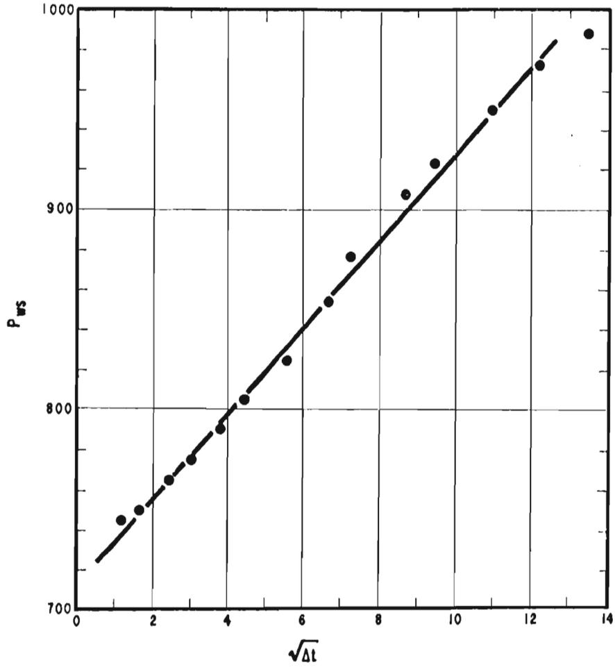
FIG. N° 26.- COMPORTAMIENTO DE DATOS DE PRESION PARA TIEMPOS CORTOS DE UN POZO FRACTURADO<sup>(31)</sup>.
