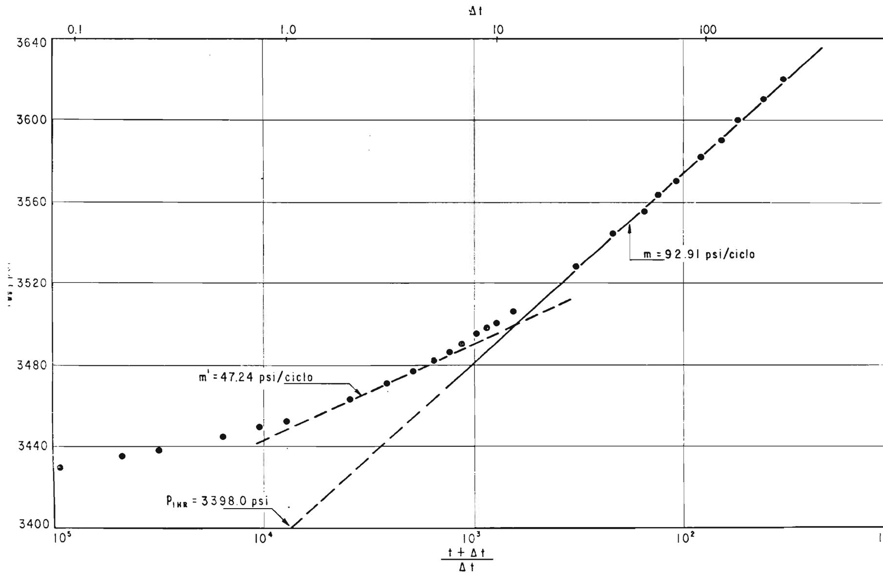
Fig. N° 32.- GRAFICA SEMILOG (HORNER y MDH) DE LOS DATOS DE INCREMENTO DE PRESION DEL EJEMPLO 1.
