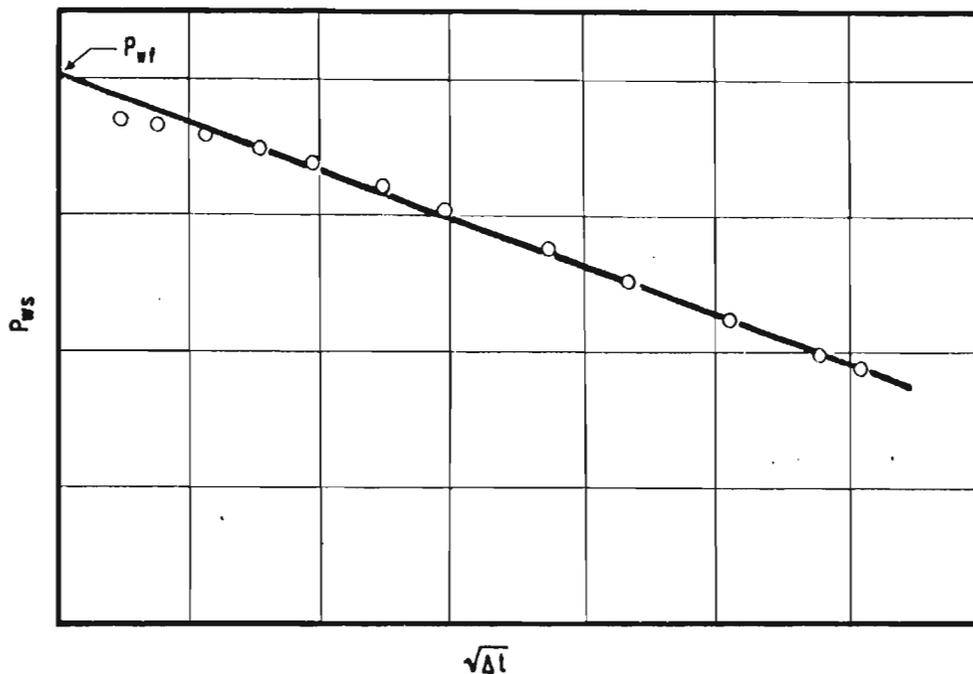
FIG. N° 23.-ANÁLISIS DE DATOS DE PRESION PARA TIEMPOS CORTOS DE UN POZO FRACTURADO CON EFECTO DE DAÑO<sup>(31)</sup>.
