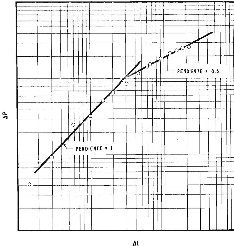
FIG. Nº 25.- GRAFICA LOG-LOG DE DATOS DE INCREMENTO DE PRESION DE UN POZO FRACTURADO CON ALMACENAMIENTO<sup>(31)</sup>.
