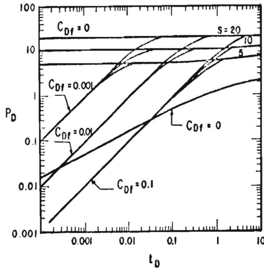
FIG. N° 27.-  $P_D$  CONTRA  $t_D$  PARA UN POZO FRACTURADO VERTICALMENTE CON ALMACENAMIENTO Y DAÑO<sup>(31)</sup>.
