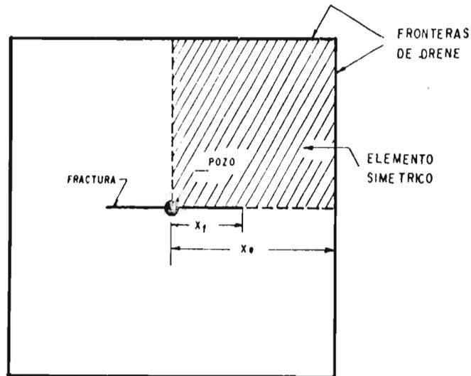
FIG. Nº 15.- PLANTA DE UN SISTEMA FRACTURADO VERTICALMENTE<sup>(27)</sup>.
