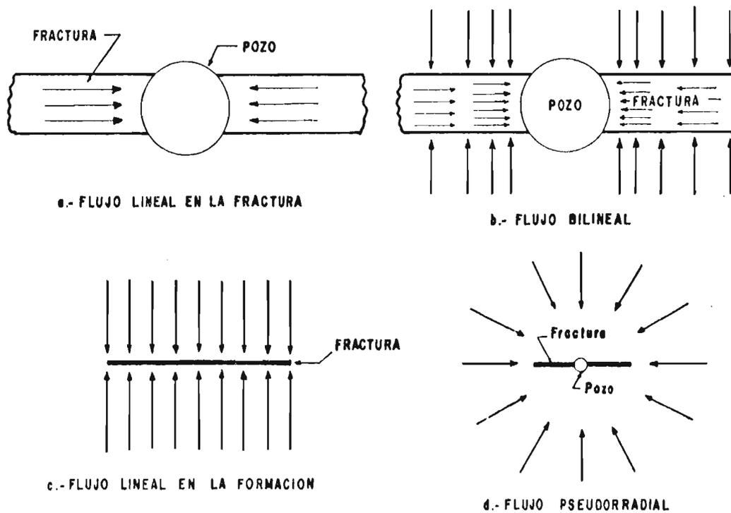
FIG. Nº 21.- PERIODOS DE FLUJO PARA UN POZO FRACTURADO VERTICALMENTE<sup>(30)</sup>.
