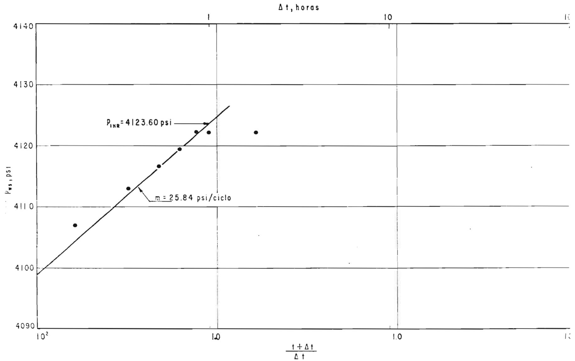
Fig. N° 38 - GRAFICA SEMILOG (HORNER y MDH) DE LOS DATOS DE INCREMENTO DE PRESION DEL POZO AKAL N° 3, EJEMPLO 3.
