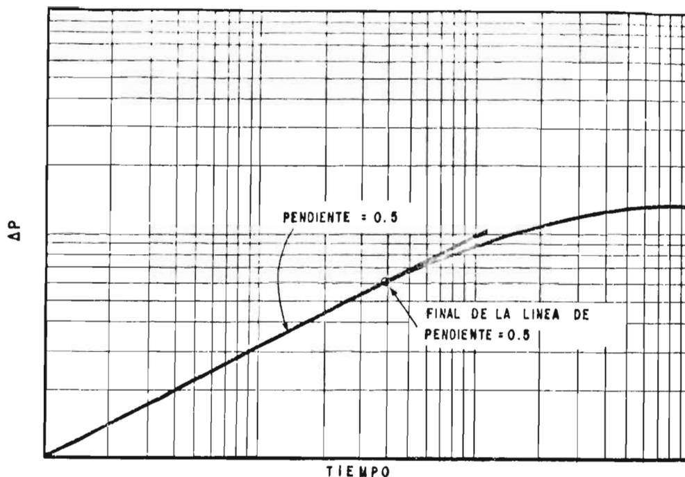
FIG. N° 28.- TENDENCIA GENERAL DE LOS DATOS DE PRESION DE UN POZO QUE INTERSECTA UNA FRACTURA VERTICAL<sup>(6)</sup>.
