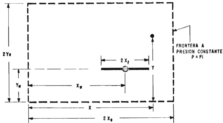
FIG. Nº 18.- FRACTURA VERTICAL EN UN YACIMIENTO RECTANGULAR CON FRONTERAS A PRESION CONSTANTE<sup>(29)</sup>.
