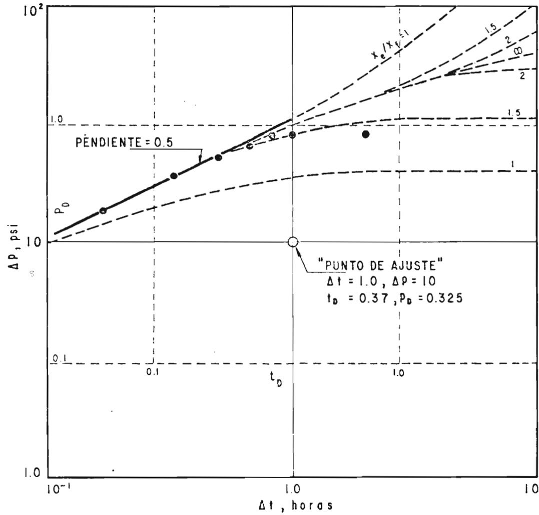
Fig. N<sup>o</sup> 37 - CURVA DE DATOS EN PAPEL LOG-LOG DEL POZO AKAL N<sup>o</sup> 3, EJEMPLO 3.
