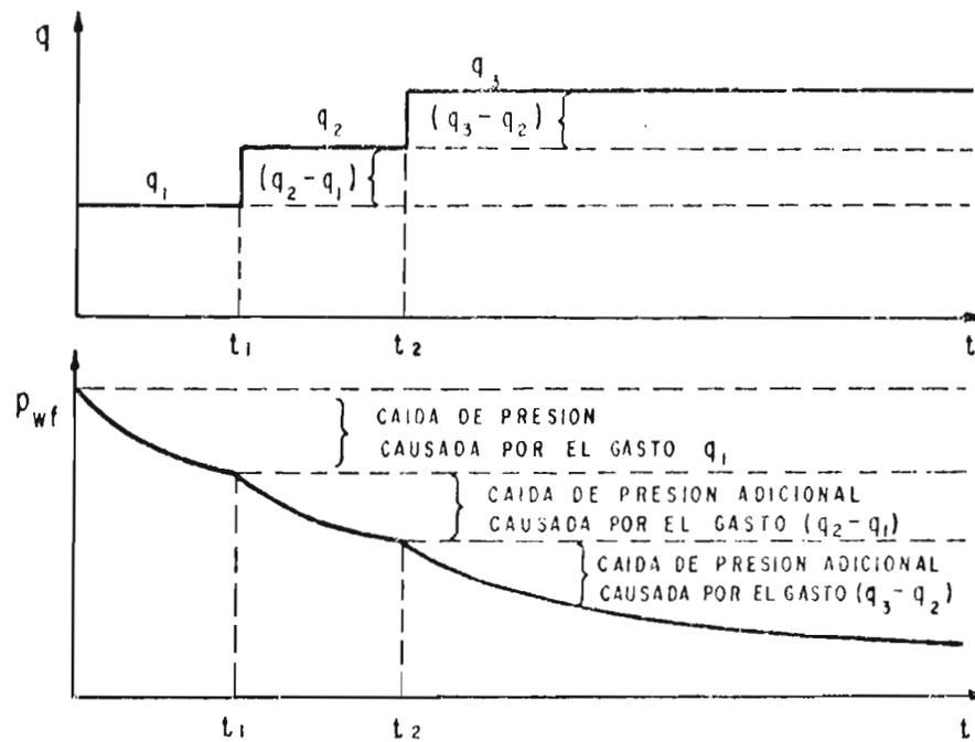
FIG. N° F-1: HISTORIAS DE PRODUCCION Y PRESION DE UN POZO QUE PRODUCE A GASTOS VARIABLES<sup>(1)</sup>.
