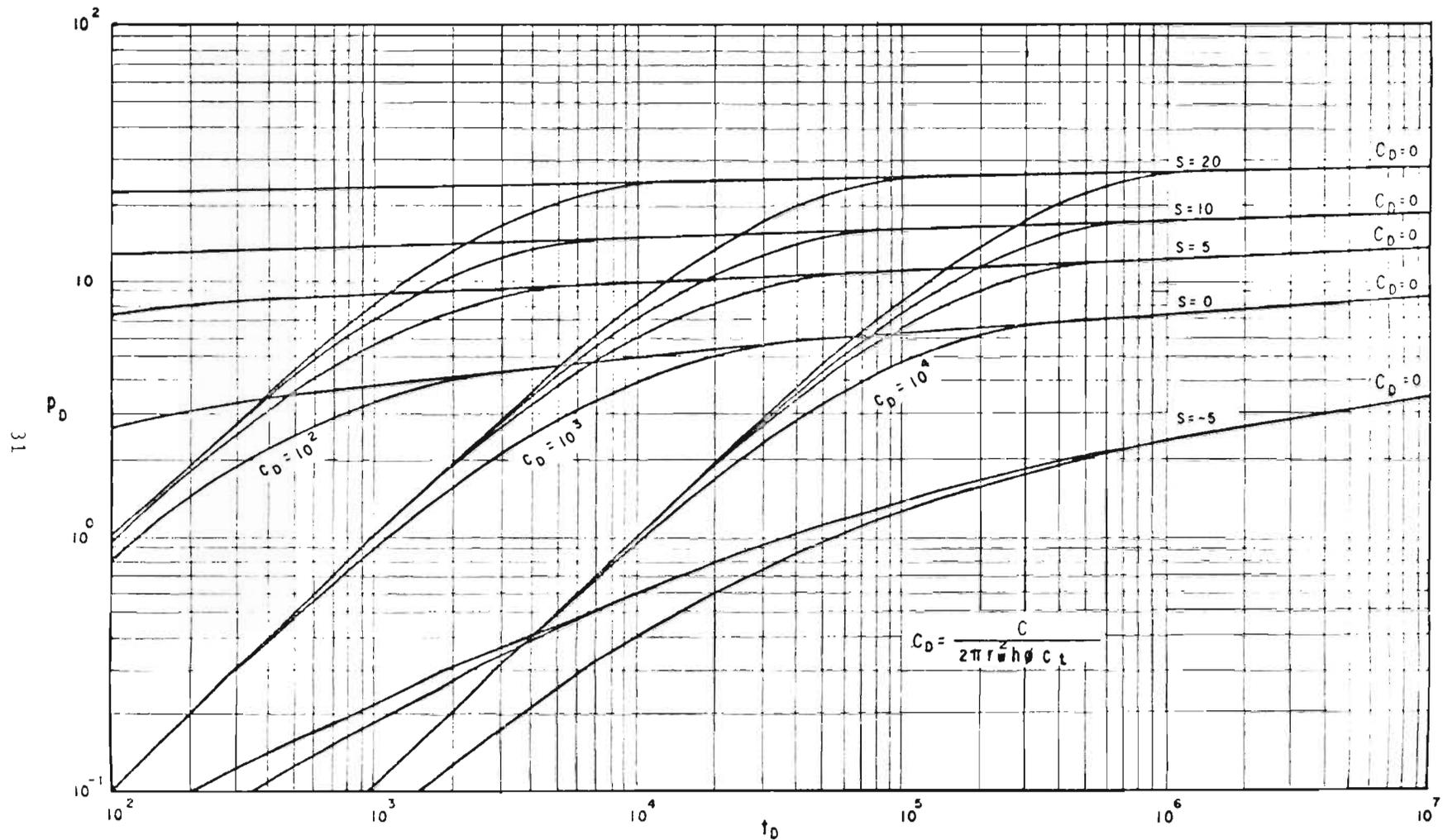
FIG. N° 7 -  $P_D$  CONTRA  $t_D$  PARA UN SOLO POZO EN UN YACIMIENTO INFINITO CON ALMACENAMIENTO Y DAÑO<sup>(21)</sup>
