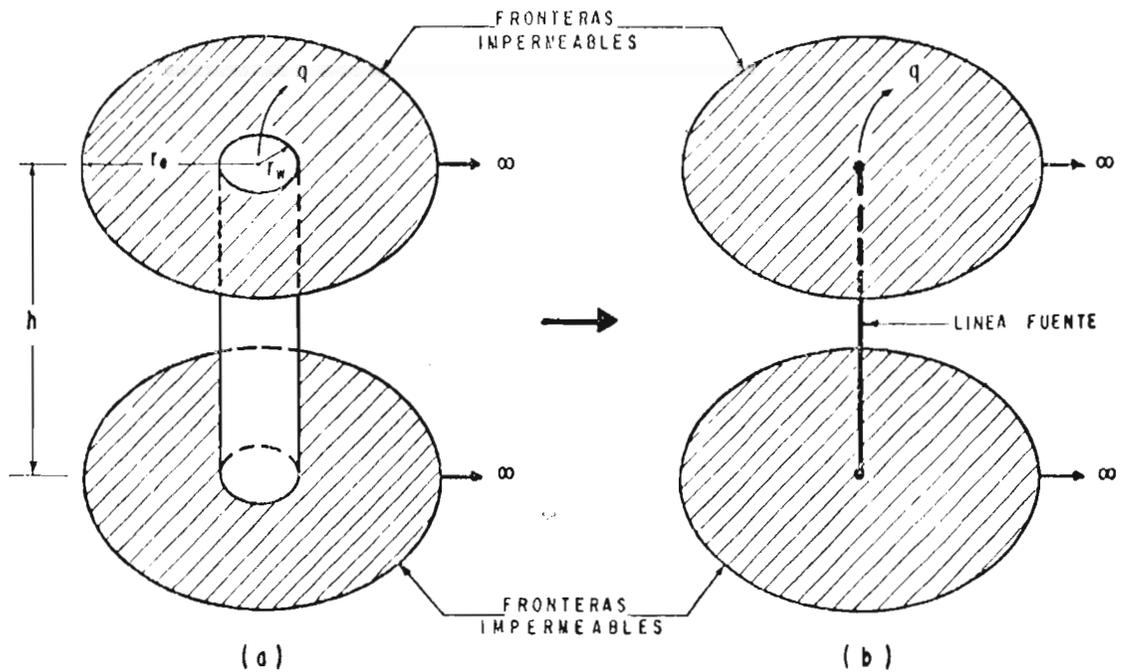
FIG. Nº B -1- REPRESENTACION ESQUEMATICA DE UN YACIMIENTO INFINITO PARA LA SOLUCION DE LINEA FUENTE<sup>(16)</sup>.
