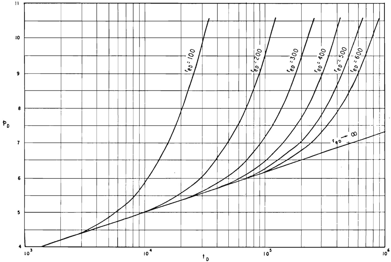
FIG. N<sup>o</sup> 3= SOLUCION PARA UN YACIMIENTO CIRCULAR LIMITADO<sup>(13)</sup>.
