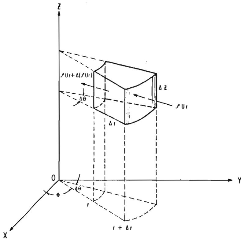
FIG. Nº A-1: VOLUMEN ELEMENTAL UTILIZADO EN LA DERIVACION DE LA ECUACION DE CONTINUIDAD PARA FLUJO RADIAL .
