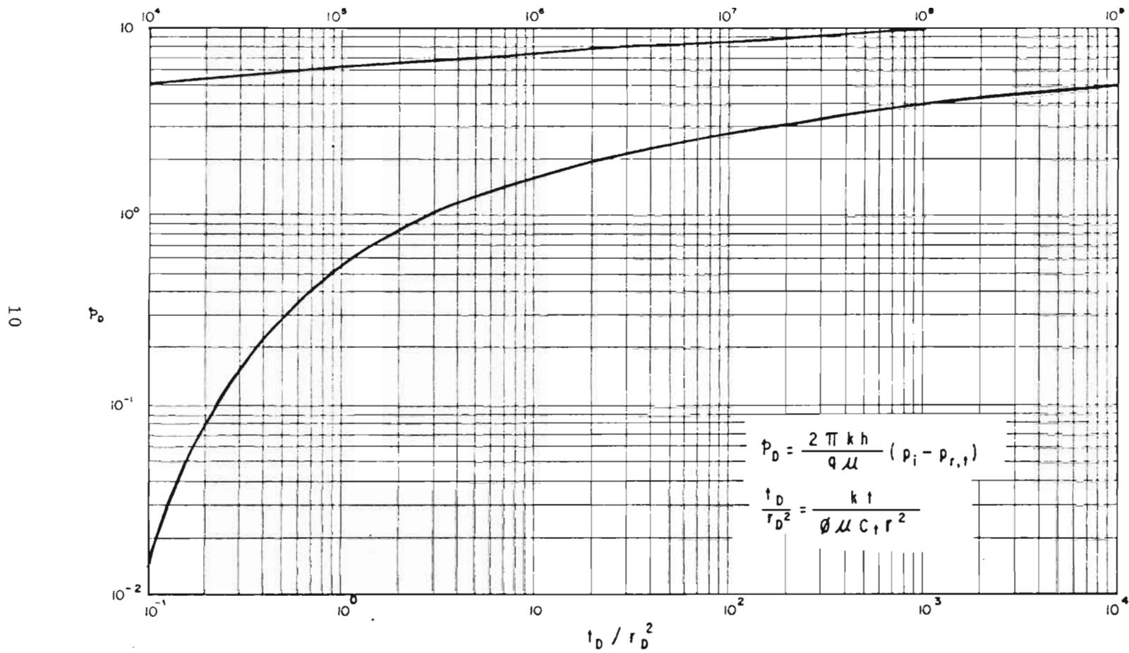
FIG. N° 1: PRESION ADIMENSIONAL PARA UN SOLO POZO EN UN YACIMIENTO INFINITO. SOLUCION DE LINEA FUENTE<sup>(12)</sup>.
