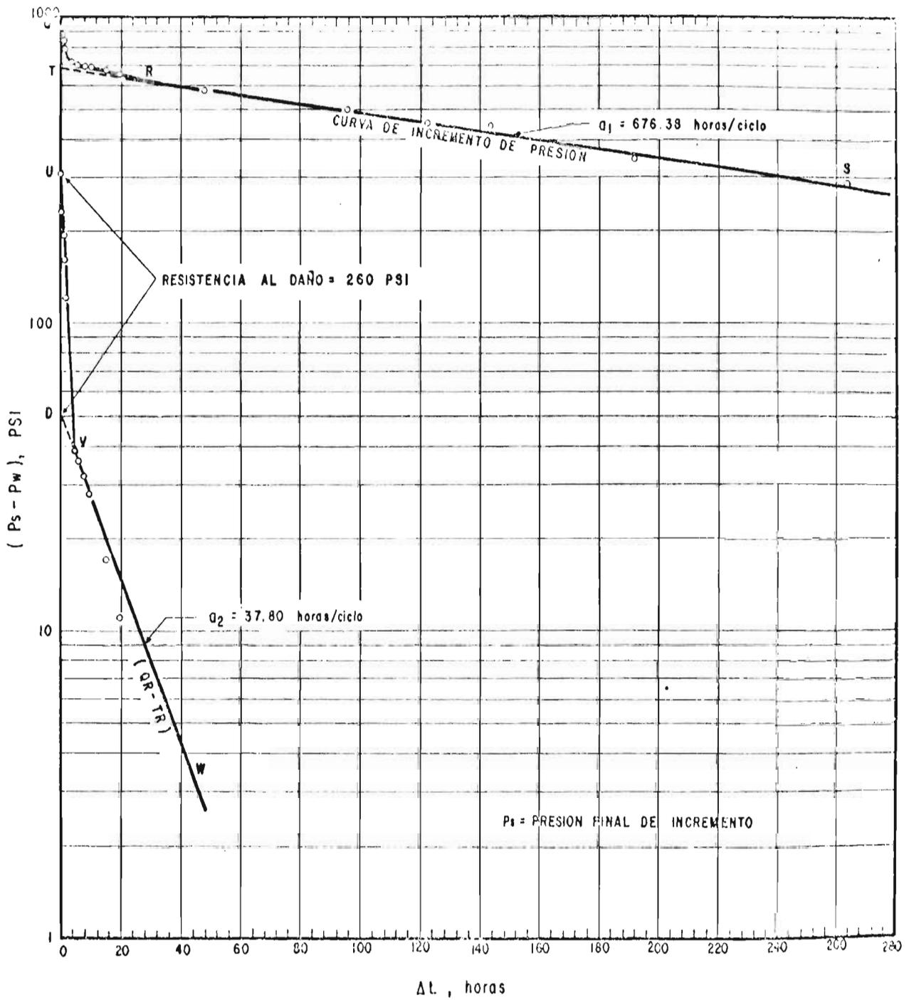
FIG. N° 39.- GRAFICA DE LOS DATOS DE INCREMENTO DE PRESION UTILIZANDO LA TECNICA DE POLLARD, EJEMPLO 4.
