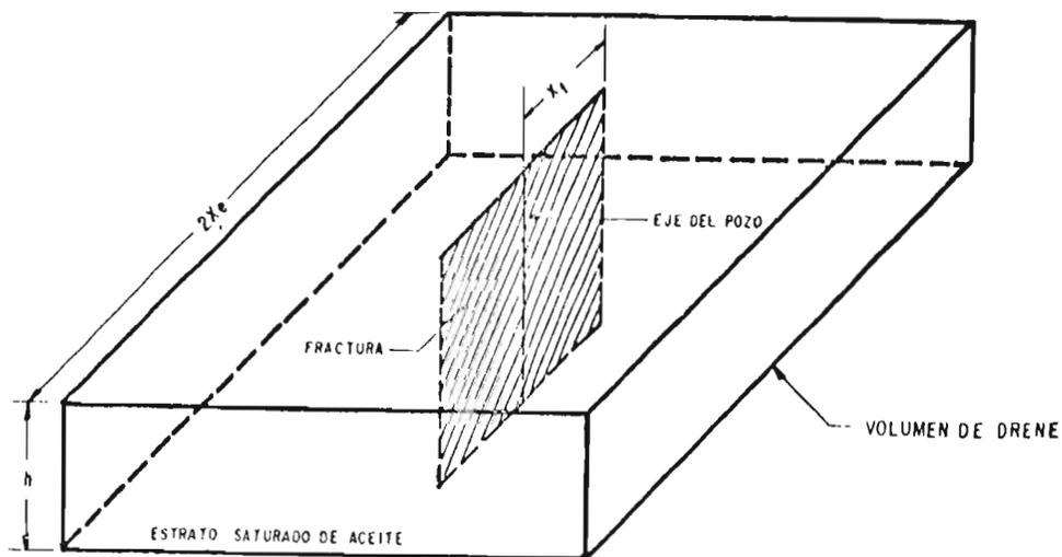
FIG. Nº 14 : ESQUEMA DE UN POZO FRACTURADO VERTICALMENTE<sup>(27)</sup>
