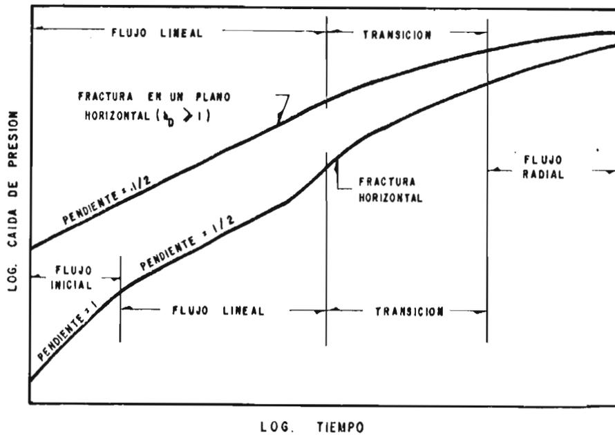
FIG. No.12.- PERIODOS DE FLUJO PARA FRACTURAS HORIZONTALES<sup>(8)</sup>
