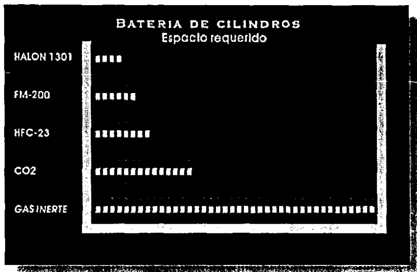
Fig. 16. Comparación del espacio físico de los cilindros de gas FM-200 con otros agentes extintores.
