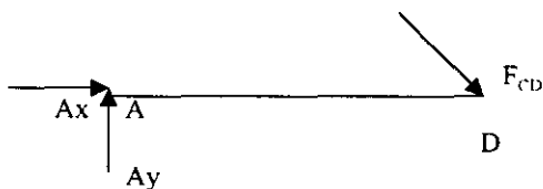
Figura 9.- Diagrama de cuerpo libre del eslabón AD
