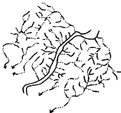
Fig. V. 11.- Drenaje anular y enrejada.
