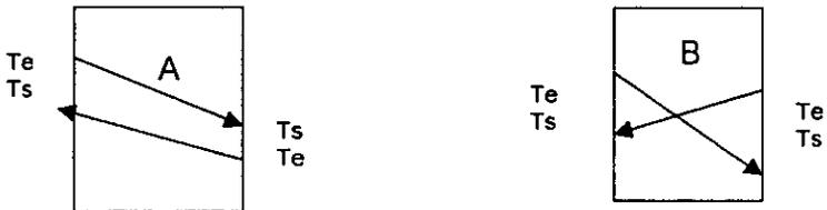
**Figura 15. Ejemplo de intercambiador que cumple termodinámicamente (A), intercambiador que no cumple (B).**
