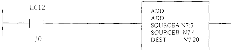
Figura 3.27 Ejemplo de un escalón de programación para un PLC.
