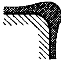
Figura II-10 Revestimiento en esquinas poco redondeadas.
