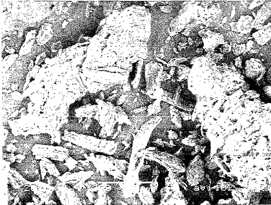
Figura 11.5. Micrografía de Microscopia Electrónica de Barrido (MEB) de Avicel PH 102, a 100 aumentos.
