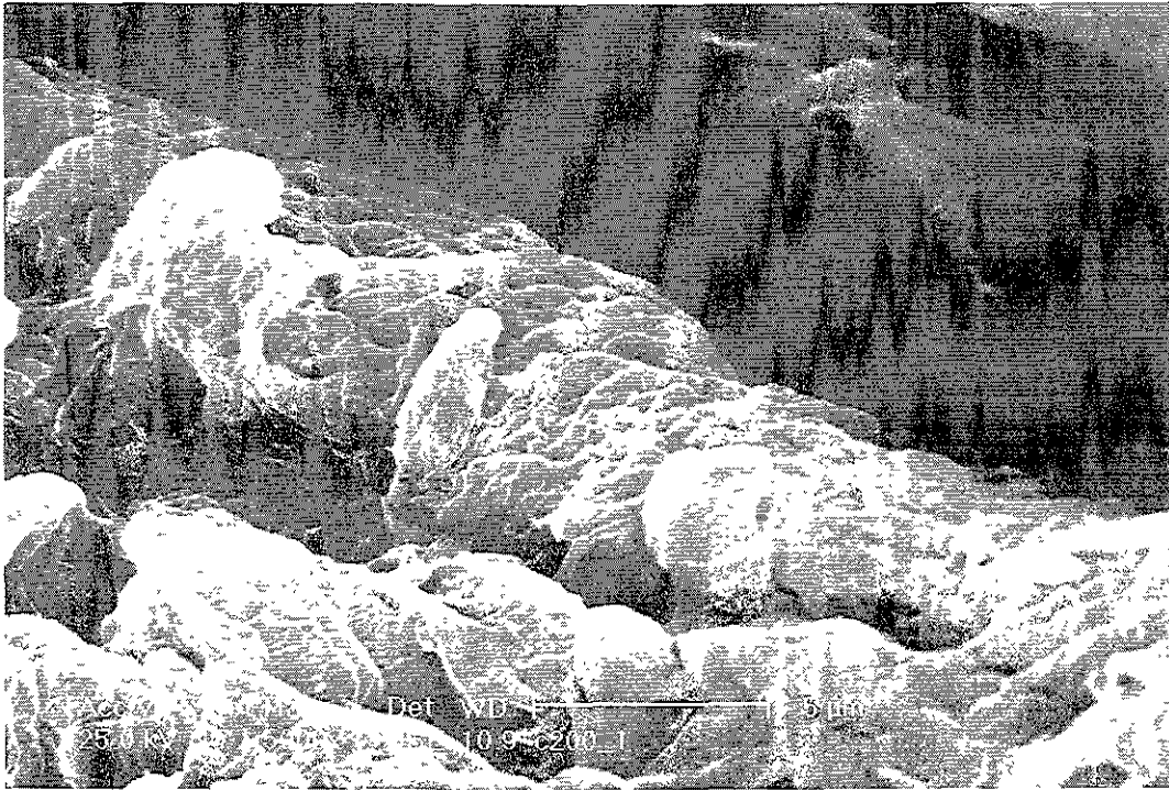
Figura 7.18. Micrografía de MEB de Helmeel 200 (lote 1) a 5000 aumentos.
