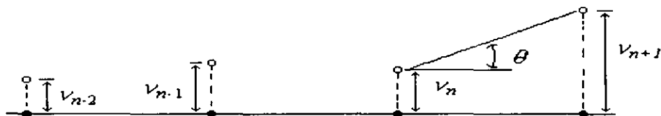
Figura 3.3.2. Vibraciones transversales de una cadena unidimensional formada por partículas idénticas igualmente espaciadas. Los círculos sólidos y abiertos representan las posiciones de equilibrio y desplazadas de este de las partículas, respectivamente.
