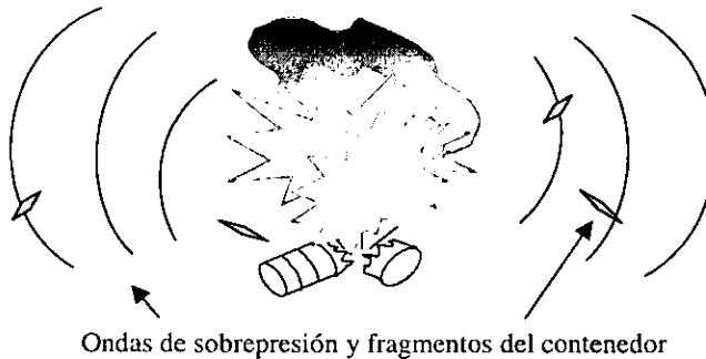
Figura 2.5 Ilustración de un BLEVE
