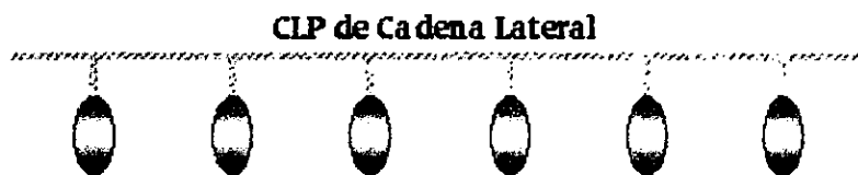
Figura 3.15 Esquema de cristal líquido polimérico de cadena lateral
