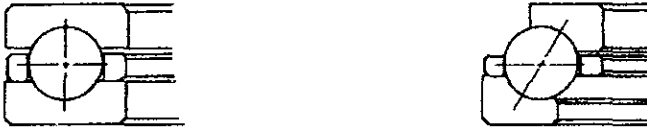
FIG 3 10 COJINETES DE BOLAS DE EMPUJE Y DE BOLAS DE EMPUJE DE CONTACTO ANGULAR
