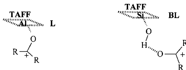
Esquema 15. Activación del carácter electrofílico del grupo carbonilo mediante los sitios ácidos de Lewis ( L ) y de Brønsted-Löwry ( BL ) del Tonsil Actisil FF.
