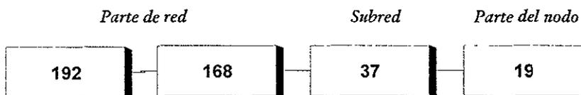
Figura 2.1 Ejemplo de una dirección IP
