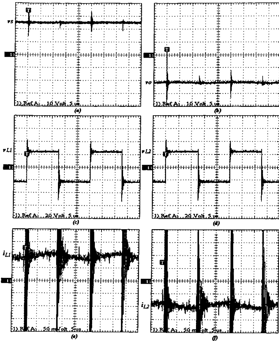
Figura 4.3 Formas de onda del convertidor de Cuk en su versión más simple. Tensión de entrada " V_s " (a), tensión de salida " V_o " (b), tensión en el inductor L1 " v_{L1} " (c), tensión en el inductor L2 " v_{L2} " (d), corriente en el inductor L1 " i_{L1} " (e), corriente en el inductor L2 " i_{L2} " (f)
