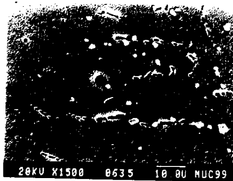
Foto5.30: Esferoidización del Si en la ZAC.
