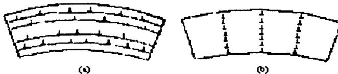
Figura 2.1-4 dislocaciones de alta y baja energía de deformación, normales a los planos de deslizamiento.
