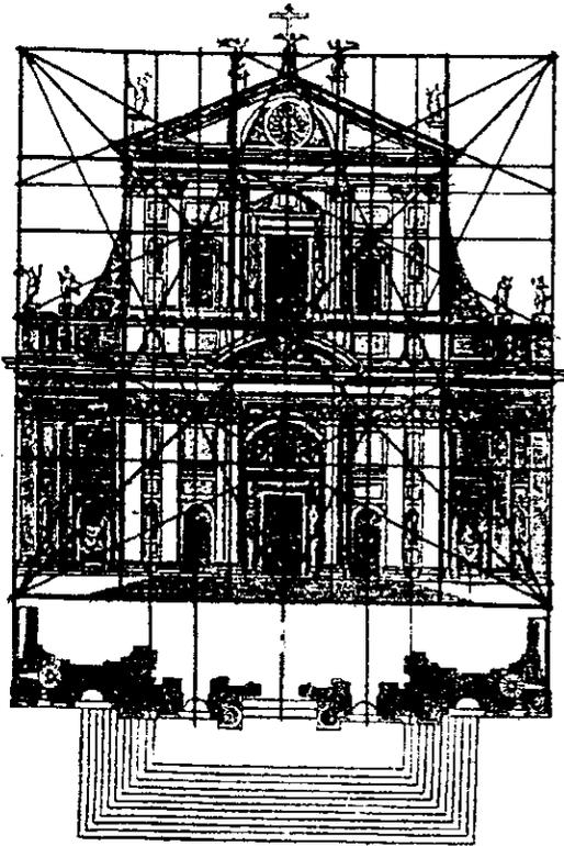
Fig. 79 Trazo de la fachada de Il Gesú. Diseño de Vignola.
