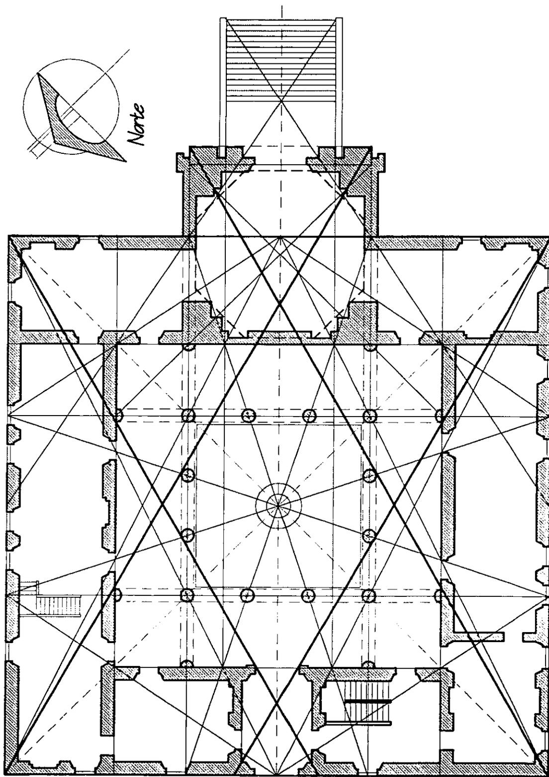
Fig. 134 Correspondencia del trazo con la planta, Palacio del Obispado.
