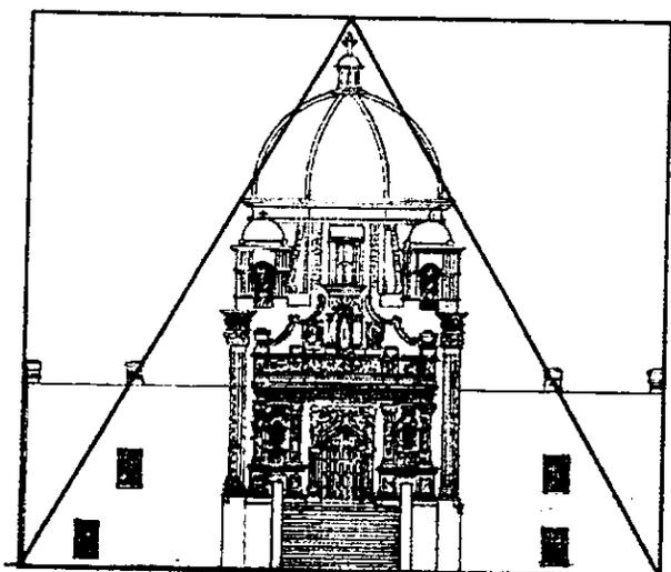
Fig. 23 Fachada del Obispado y la aplicación del triángulo equilátero.
