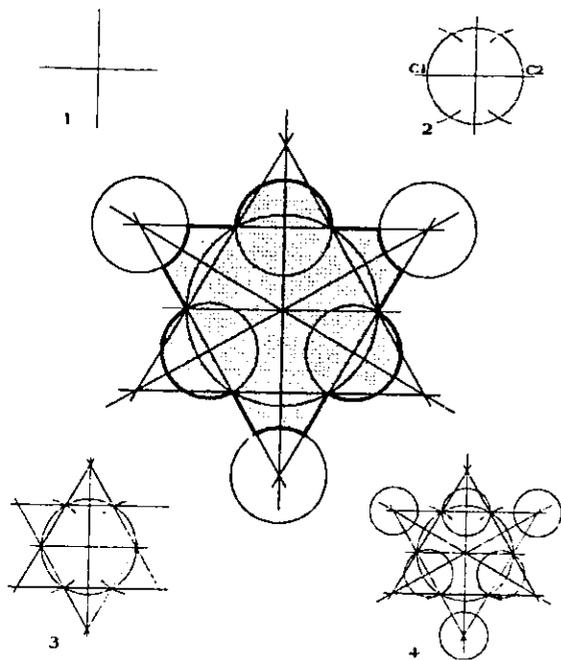
Fig. 87 Trazo geométrico de la planta de S. Ivo de la Sapienza en Roma, F. Borromini (según L. Benévolo)
