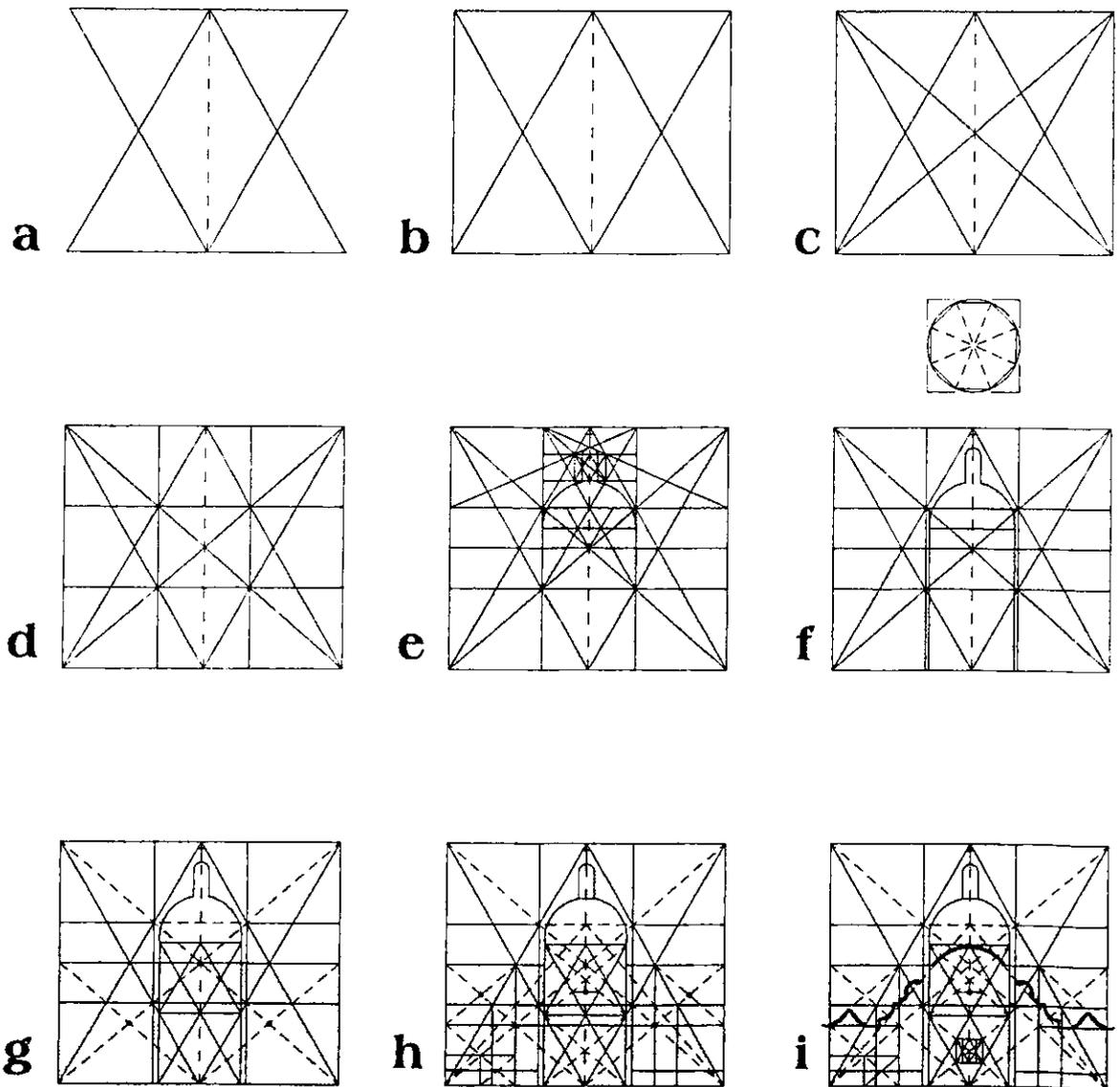
Lámina VI, conmodulación de la Fachada del Sagrario Metropolitano
