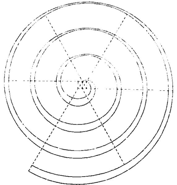
Fig.42 Espiral con dos triángulos equiláteros sobrepuestos.
