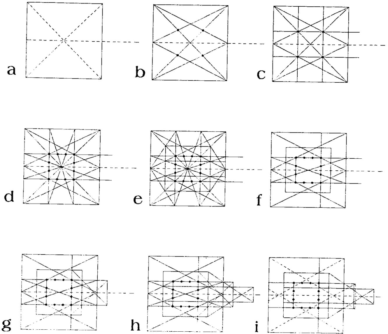
Lámina IV. Proceso continuo del trazo de la planta, Obispado de Monterrey.
