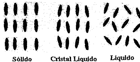
Figura 3.10. Ejemplificación del orden en algunas de las fases de la materia condensada.
